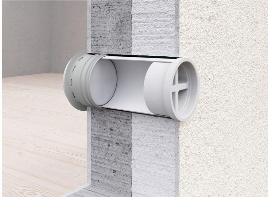
Un carottage de 162mm - 165mm (diamètre standard 150mm) est nécessaire pour préparer le montage du kit pour le gros œuvre. Le kit pour le gros œuvre est adapté pour toutes les épaisseurs de mur usuelles (220mm - 550mm). Le manchon de raccordement mural flexible est enfoncé dans le mur du côté de la cuisine en même temps que le tuyau de la traversée murale. Il sert ensuite de pièce de raccordement directe pour tous les raccords de conduits circulaires du système de conduits.
