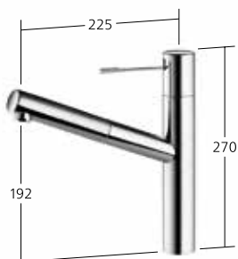
Hebelmischer – Bedienungshebel aus Medizinalstahl – Auszugauslauf – bis 700 mm ausziehbar – Schlauchoberfläche passend zu Armatoberfläche – Schlauchdurchführung, schwenkbar 105°
