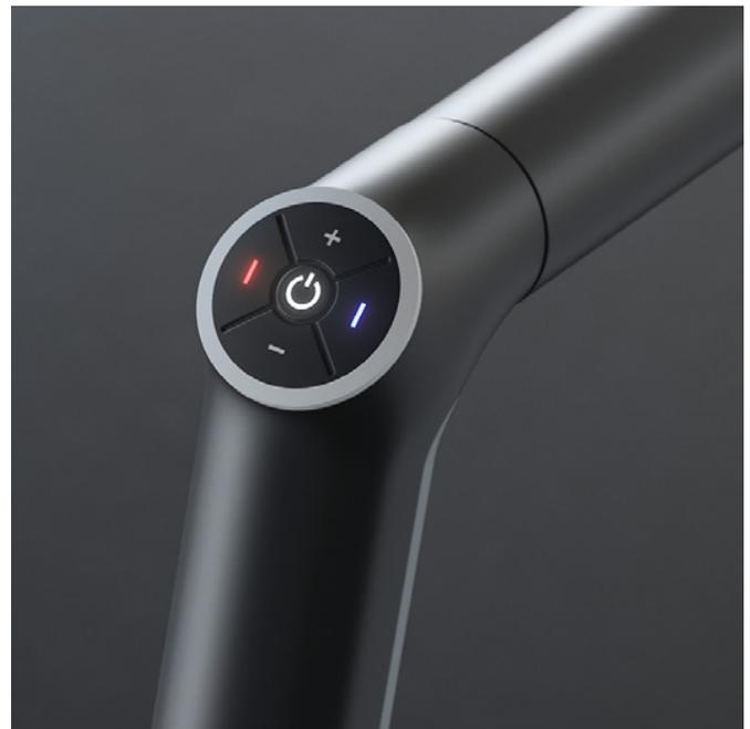
Rund um die Bedien-Tastatur ist ein separater Leuchtring angeordnet, unter welchem RGB-LED's hinterlegt sind und entsprechend der Sollwassertemperatur leuchtet (Blau für Kaltwasser, Orange für Mischwasser, Rot für Warmwasser).
