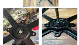
3. Fixieren Sie das Kreuz von unten in folgender Reihenfolge: U-Scheibe, Federring und Mutter. (sehr fest anziehen)
