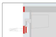
Schiene mit Gummiunterlagen und Gummitüllen befestigen, Schrankdeckel oder Seitenwände mit Gummiband entkoppeln.
