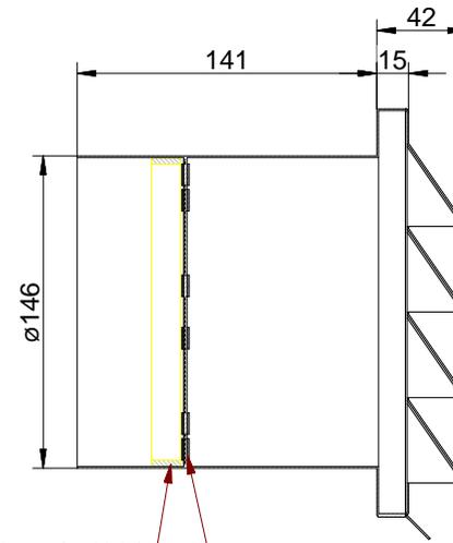
Moosgummi-Dichtung (verklebt) Rückstauklappe
