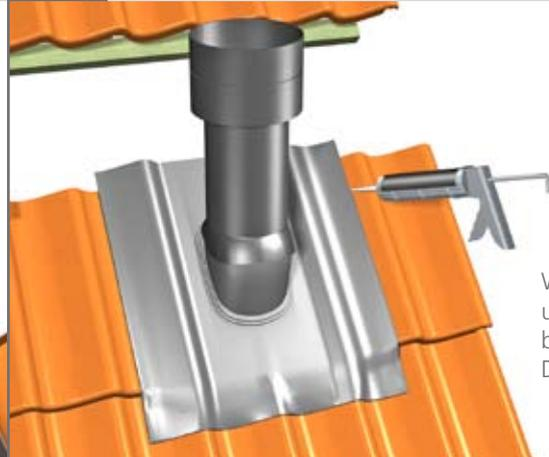
Wir empfehlen die umlaufende Verklebung der Ränder mit Dichtmasse.
