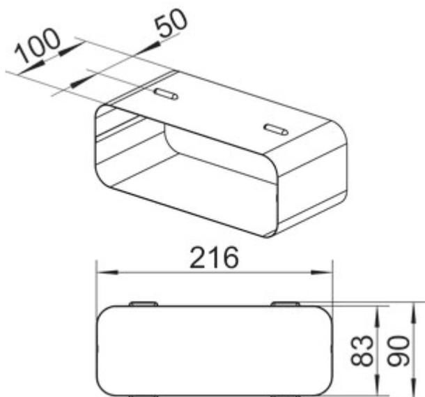
✓ Élément de raccordement
