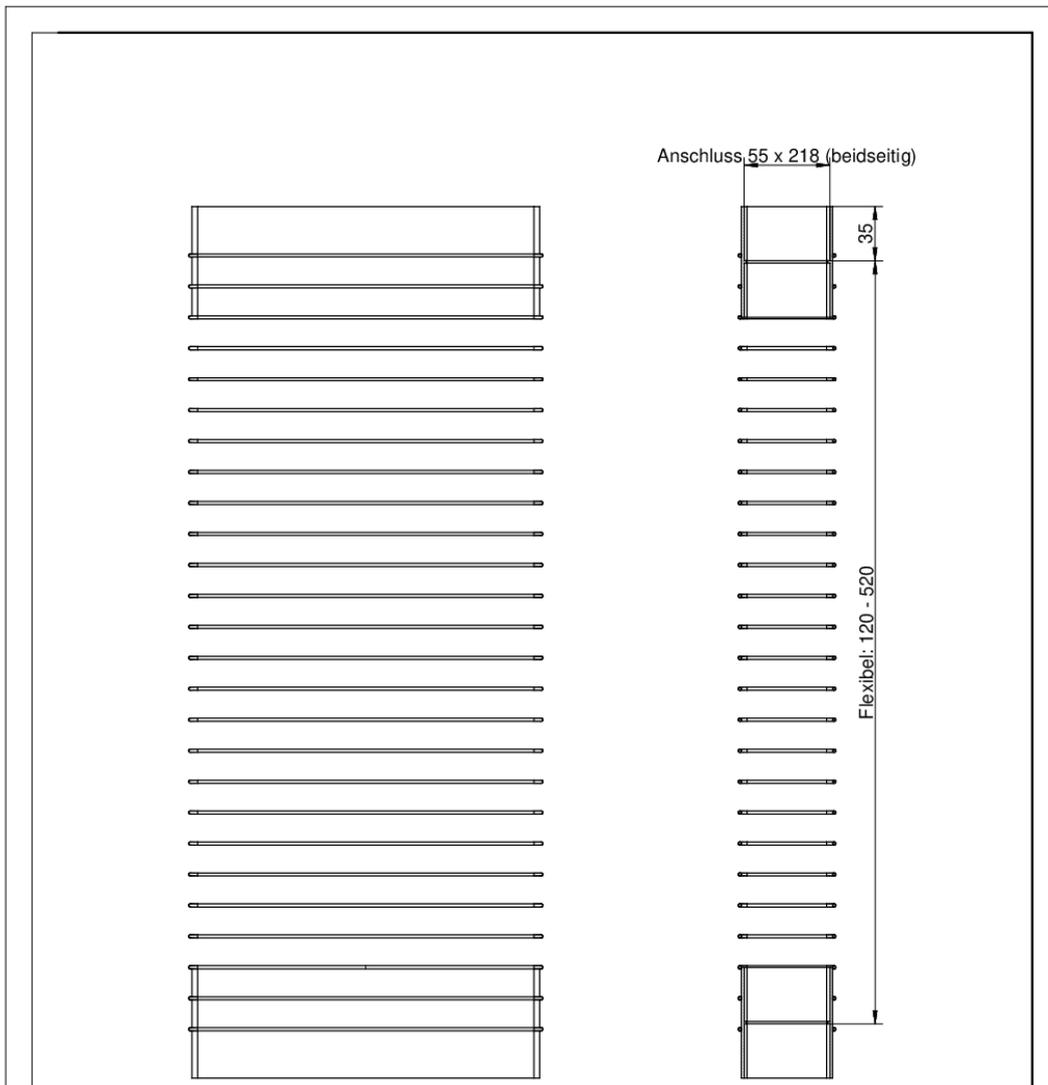
Flexibler Schlauch mit PVC ummantelten Drahtspiralen
