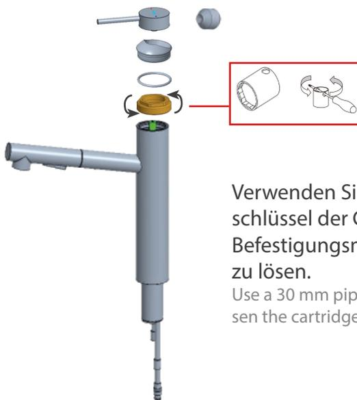
Verwenden Sie einen Rohrsteckschlüssel der Größe 30 mm um die Befestigungsmutter der Kartusche zu lösen.
