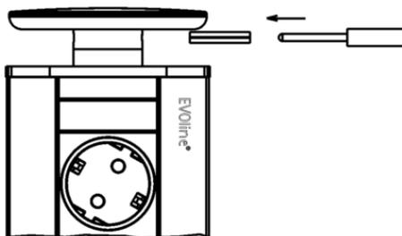
Hülse mit Schraubendreher oder ähnlichem Werkzeug wieder einschieben; Deckel dabei festhalten und darauf achten, dass die Bohrungen konzentrisch liegen.
